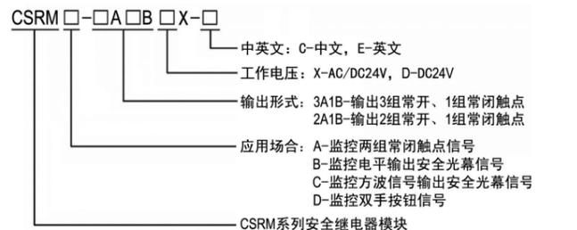
注: 3A1B 模块和 B 型模块的工作电压为 DC24V, 2A1B 的 A/C/D 型模块的工作电压为 AC/DC24V
